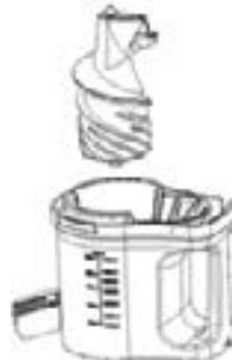
Befestigen Sie die Förderschnecke in der Mitte des Siebs und drehen Sie sie bis sie richtig eingerastet ist.
