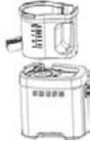
Befestigen Sie die Schale am Hauptteil indem Sie die zwei Verriegelungspunkte auf gleiche Höhe bringen.
